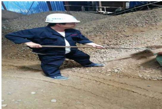
图 9.4 土方加工后取样检验
