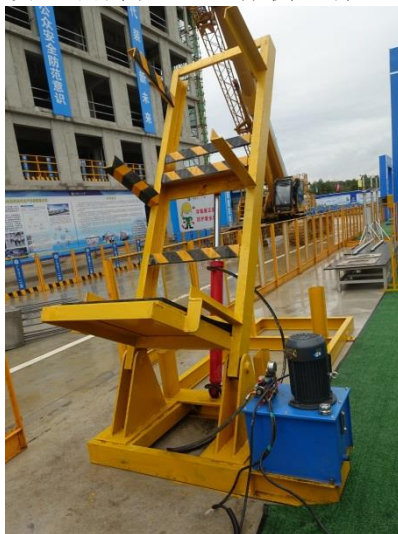
照片 33 PC 柱侧立架空载试验
