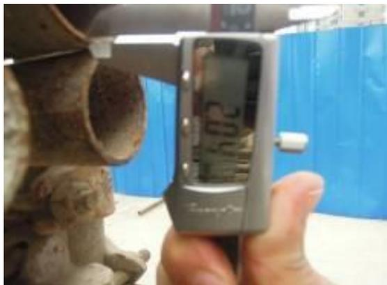
钢管壁厚与三年前的调查结果相比，钢管最薄壁厚从 2.5 降到了 2.01mm，壁厚离散程度加大，平均壁厚呈下降趋势。
