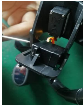
舵机云台摄像安装
