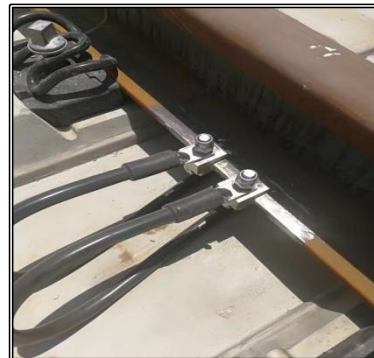
图 2 轨道电路无孔连接器
